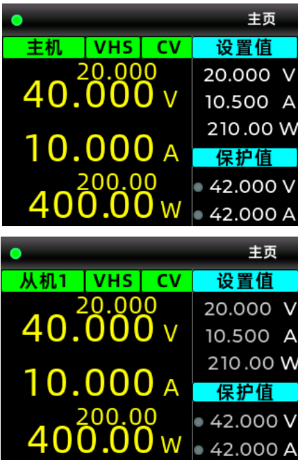
2 台电源 串联运转时的面板显示例 (输出电流 10A)
