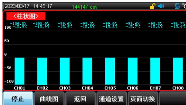
图 7-6 CH01-CH08 通道柱形图显示（温度值有正有负）
