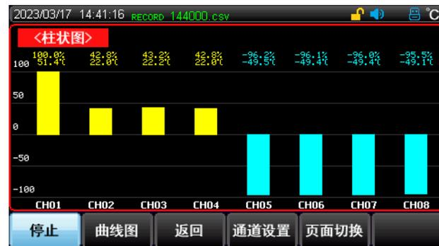
系统会根据通道的温度值正负，调整柱形向上或向下显示的情况，若测试模块没有连接，则没有显示。
